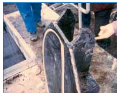
Рис. 1-с: Обратный клапан DN 800 после скачка давления в напорной трубе
