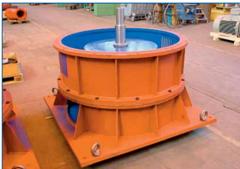
Рис. 8.1.3-б: Вертикально установленный маховик (привод от карданного вала, D = 790 мм).
