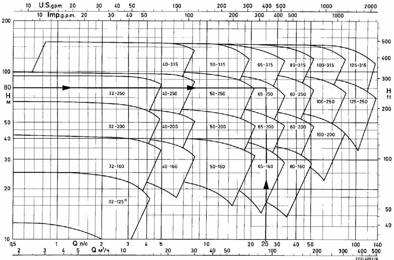
Рис. 26. Семейство характеристик типорядов СРК/НРК,  $n = 2900 \text{ 1/мин}$
