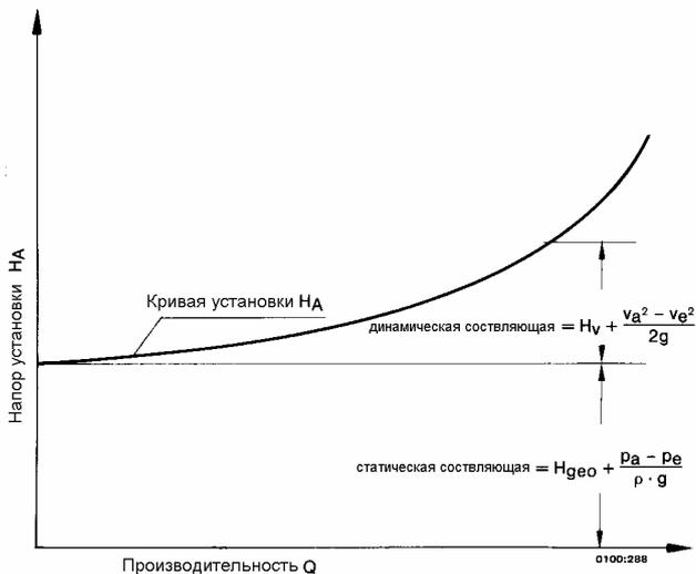
Рис. 5. Характеристическая кривая установки (характеристическая кривая трубопровода)
