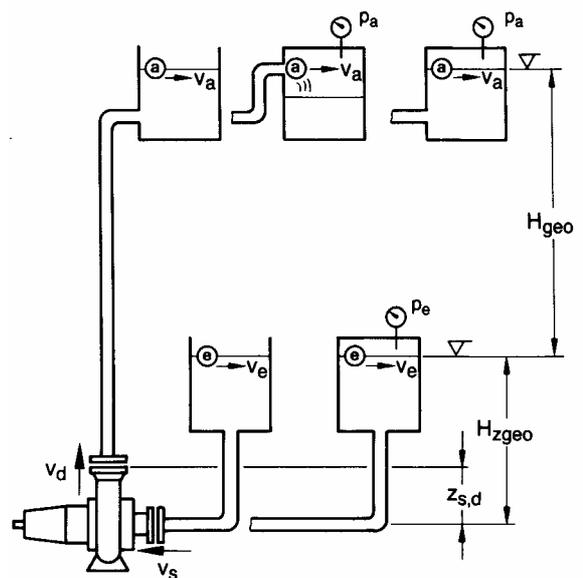
Рис. 2. Насосная установка при подводе самотёком
