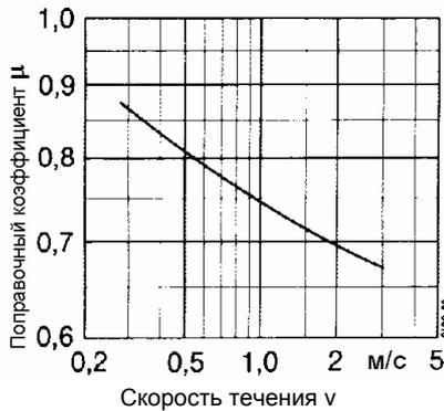
Рис. 14. Поправочный коэффициент  $\mu$  для пересчёта потерь напора в чугунной трубе, при температуре воды  $20^\circ\text{C}$ , на значения для пластмассовой трубы, при температуре воды  $10^\circ\text{C}$ , изображение в зависимости от скорости течения  $v$
