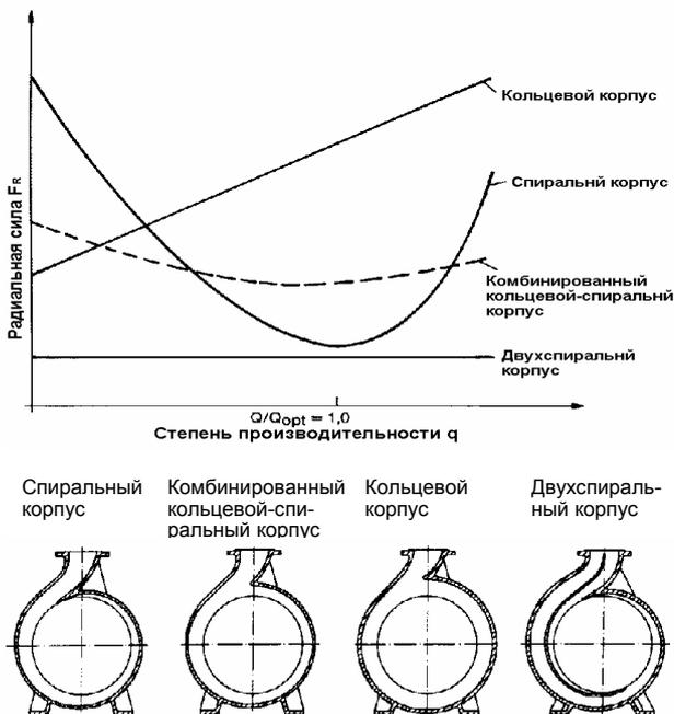
Рис. 30. Характеристика радиальной силы при различных формах корпуса
