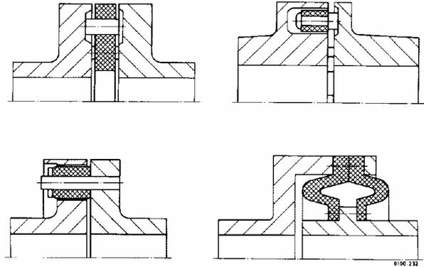
Рис. 50. Типы конструктивного исполнения муфт (примеры)
