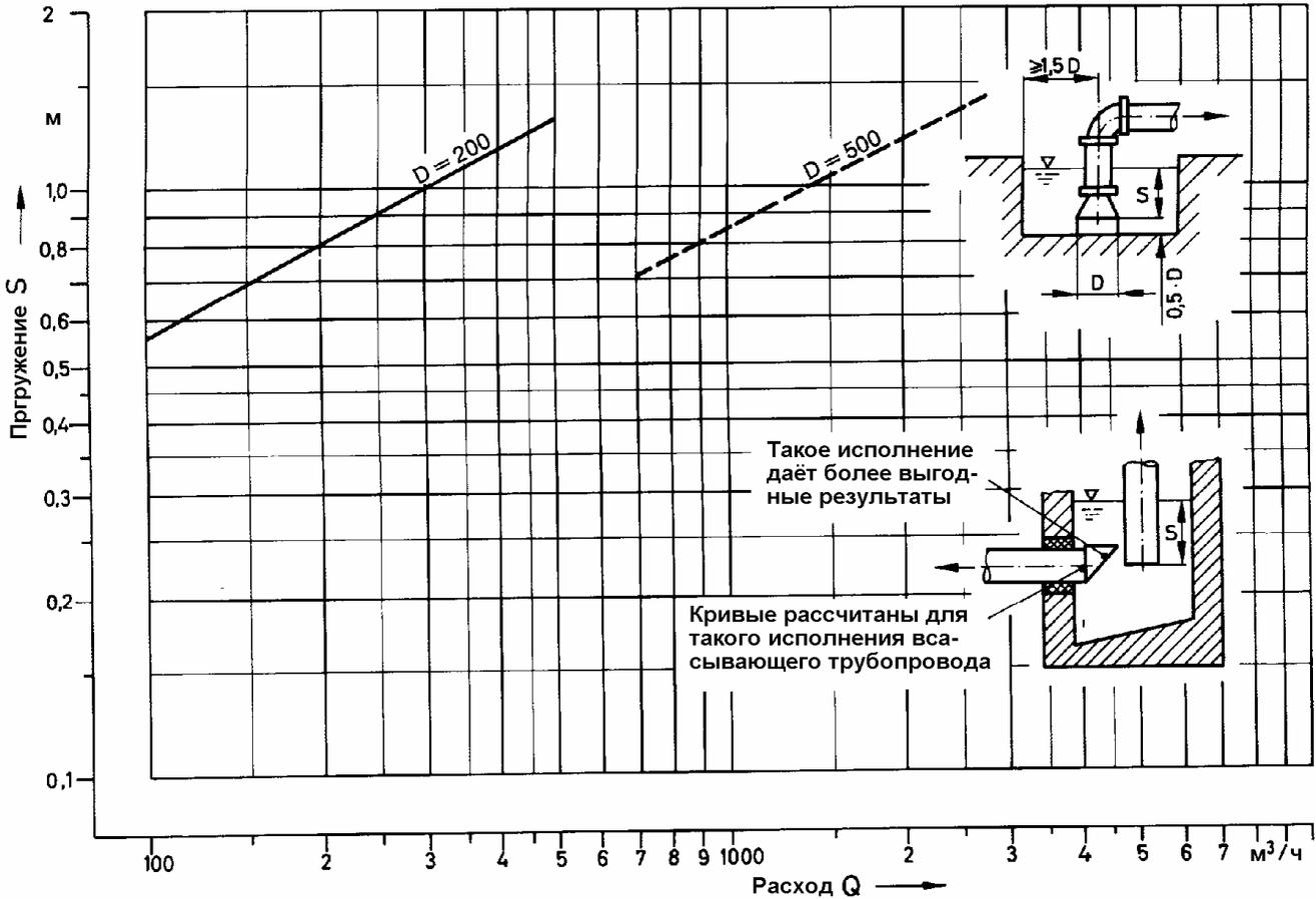
Рис. 45. Погружение  $S$  в зависимости от входного диаметра всасывающего трубопровода  $D$  и расхода  $Q$
