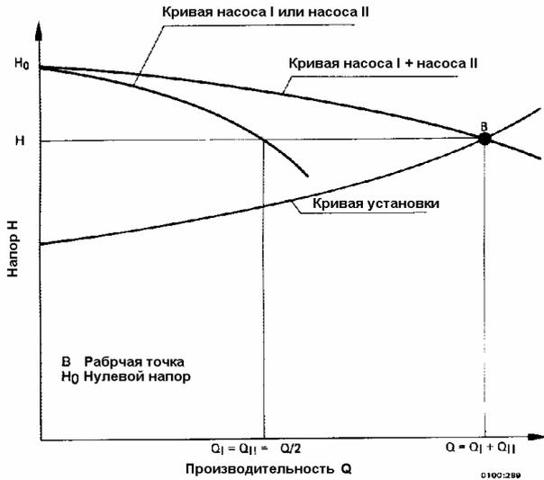
Рис. 8. Параллельная эксплуатация двух одинаковых по величине насосов с одинаковыми нулевыми напорами  $H_0$
