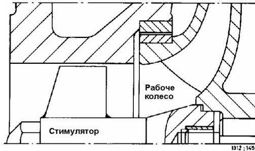
Рис. 32. Центробежный насос с предвключённым ротором (стимулятором)
