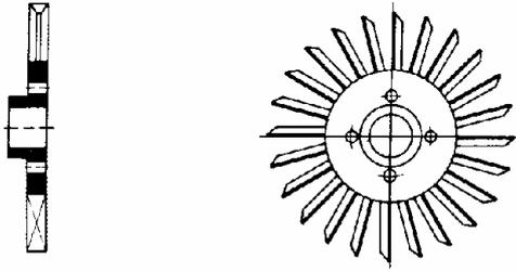
Звёздчатое колесо для вихревого насоса
